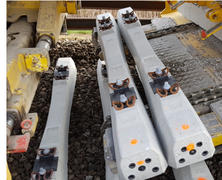
MCEM II A-LL, CO 2 -arme Zemente, Versuchsstrecke Ingolstadt, DE
